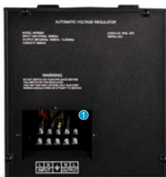
1. Bornera Conexión entrada y salida
